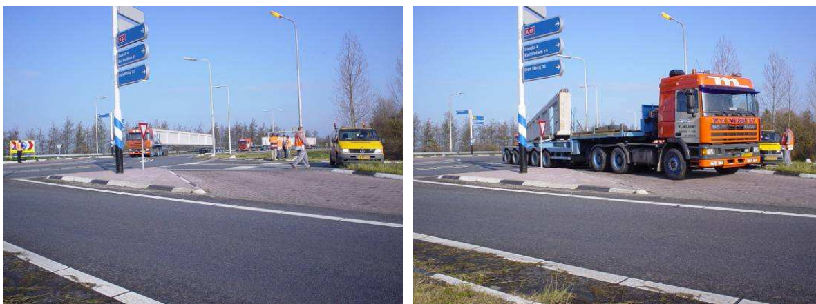
Figuur D.4-5 Exceptioneel transport met ontheffing en begeleiding (transport voorgespannen betonnen balken via turborotonde N 459/A12-noord)
